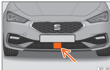
Obr. 171 Na předním nárazníku: radarový snímač.
