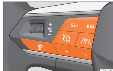
Obr. 190 Levá strana multifunkčního volantu: tlačítka k ovládání systému Travel Assist.
