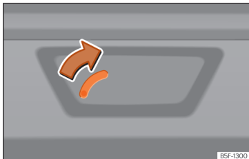
Obr. 99 Detail zavazadlového prostoru: nouzové odemknutí (Leon Sportstourer).
