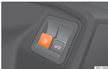
Obr. 222 Dveře řidiče: odjistění víka plnicího hrdla palivové nádrže.
