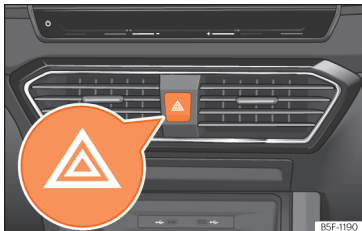
Obr. 105 Přístrojová deska: spínač výstražných světel.
