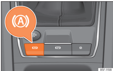
Obr. 199 Ve spodní části středové konzoly: tlačítko funkce Auto Hold.
