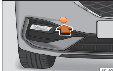
Obr. 52 Na pravé straně předního nárazníku: odstranění krytu.
