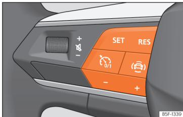
Obr. 177 Na multifunkčním volantu: tlačítka k ovládání tempomatu
