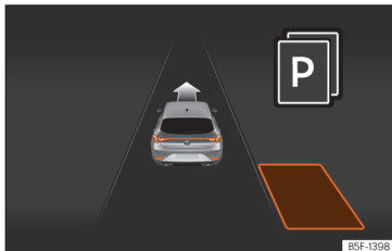
Obr. 200 Na displeji panelu přístrojů: Zobrazení parkovacího asistenta s omezenou viditelností.
