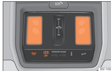
Obr. 106 Detail stropního panelu: osvětlení vnitřního prostoru vpředu.
