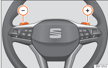
Obr. 170 Volant: páčky pro automatickou převodovku.
