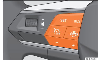
Ob. 178 Na multifunkčním volantu: tlačítka k ovládání omezovače rychlosti
