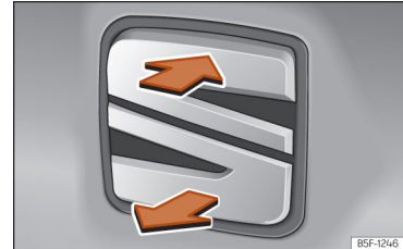
Obr. 94 Zadní víko: otevření zvenku.
