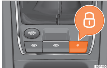
Obr. 88 Ve středové konzole: tlačítko centrálního zamykání dveří
