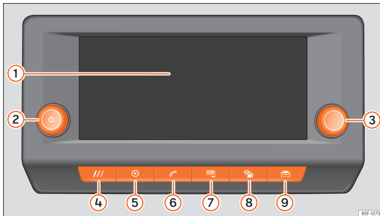
Obr. 157 Všeobecný přehled: ovládací prvky a zobrazení pro 8,25" provedení.
