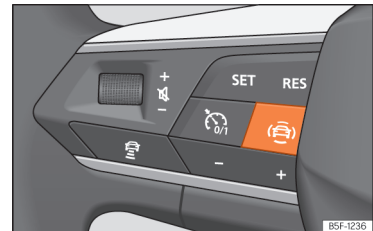
Obr. 74 Levá strana multifunkčního volantu: tlačítka asistenčních systémů řidiče (v závislosti na modelu).
