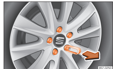
Obr. 42 Kolo: Šrouby kola s víkem. »
