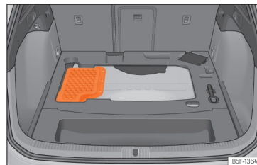
Obř. 239 Plug-in hybridní vozidla (PHEV): montážní místo akumulátoru v zavazadlovém prostoru »
