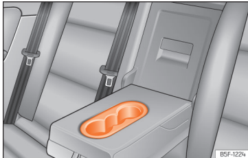
Obr. 149 Ve středové loketní opěrce vzadu: držák nápojů.
