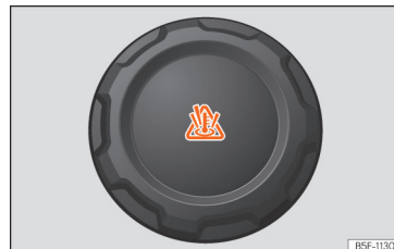
Obr. 236 Motorový prostor: uzávěr vyrovnávací nádobky chladicí kapaliny motoru.
