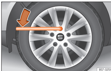
Obr. 44 Výměna kola: povolení šroubů kola.
