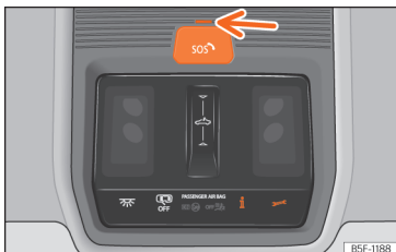
Obr. 37 Ve stropní konzole: spínač hovorových služeb
