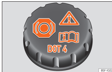
Obr. 237 Motorový prostor: uzávěr nádoby brzdové kapaliny.
