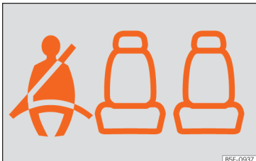
Obr. 10 Panel přístrojů: Zobrazení, že místo vzadu vlevo je obsazeno a spolucestující má připnutý bezpečnostní pás.
