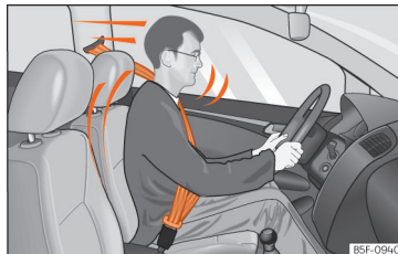
Obr. 11 Řidiči se správně připnutými pásy nebudou při náhlém brzdění vymrštnuti dopředu.
