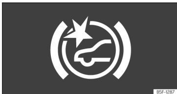
Obr. 179 Na displeji panelu přístrojů: signalizace předběžné výstrahy.
