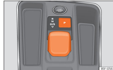
Obr. 169 Ve středové konzole: volicí páka.
