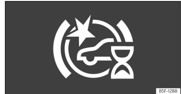
Obr. 180 Na displeji panelu přístrojů: signalizace první automatické kalibrace systému.
