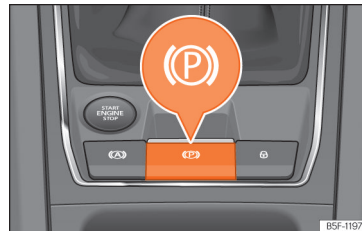
Obr. 198 Ve spodní části středové konzoly: tlačítko elektronické parkovací brzd.
