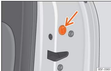
Obr. 92 Nouzová uzávěra dveří.
