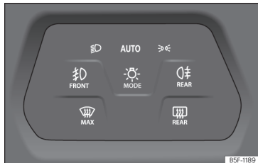
Obr. 103 Přístrojová deska: spínač světel
