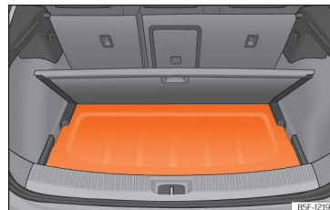
Obr. 127 V zavazadlovém prostoru: Vložení krytu zavazadlového prostoru.
