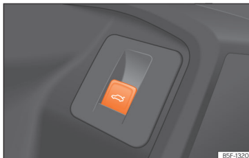
Obr. 96 Na dveřích řidiče: tlačítko pro otvírání a zavírání zadního víka.
