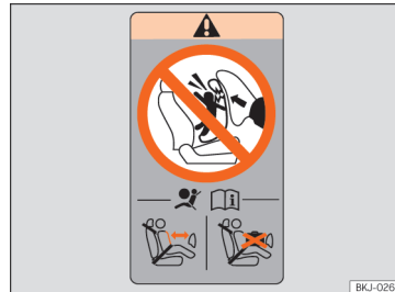
Obr. 31 Nálepka pro airbag: v zadní části rámu dveří spolujezdce
