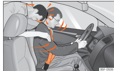
Obr. 13 Nepřipoutaný cestující na zadním sedadle je vymršten dopředu na připoutaného řidiče.
