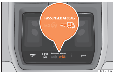
Obr. 21 Ve stropní konzole: kontrolka odpojení airbagu spolujezdce.
