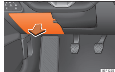
Obř. 56 Na straně řidiče v přístrojové desce: kryt pojistkové skříňky.
