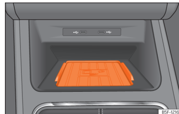
Obr. 162 Ve středové konzole: úchyt pro spřáhnutí mobilního telefonu.
