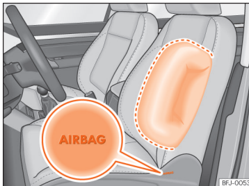
Obr. 26 Boční airbag v sedadle řidiče
